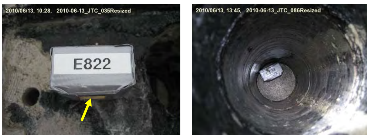
Figur 20. Foto til venstre af indpakket sensor installeret på Fiskebækbroerne. Træpladen der beskytter hullet til fugtgistreringer kan anes på undersiden af sensoren. Foto til højre viser sensor placeret i boret hul i oversiden af travers.
