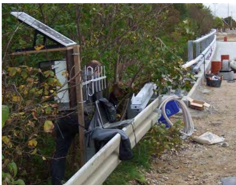
Figur 5. Transmitterboks (forgrunden) med antenne pegende mod brodek
