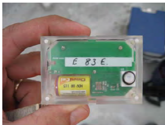
Figur 23. Foto af sensor uden ekstra indpakning. Hul til registrering af fugt er nederst til højre på sensoren.
